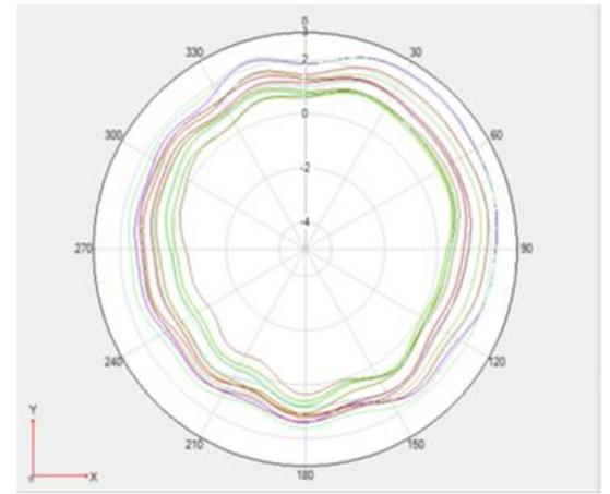
天线的垂直面方向图（V面）
