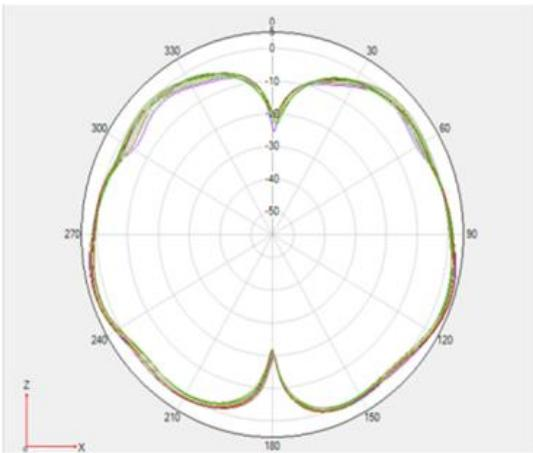
天线的水平面方向图（H面）
